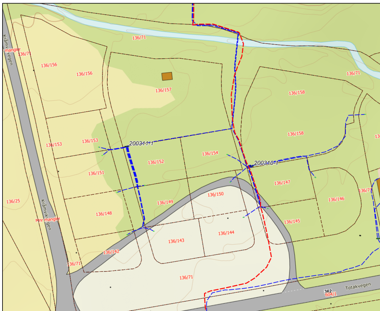
Figur 16. Raud stipla strek er høgspennet som er lagt i jord. Blå stipla strek er el-forsyning til bustadtomtene (kartet er motteke frå Rauland Kraftforsyningslag ).
