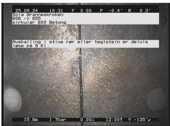
Granneskroken_656_40698.jpg, 00:02:10, 15.87m Avskalling i stive rør eller teglstein er delvis løse på 9 Kl.
