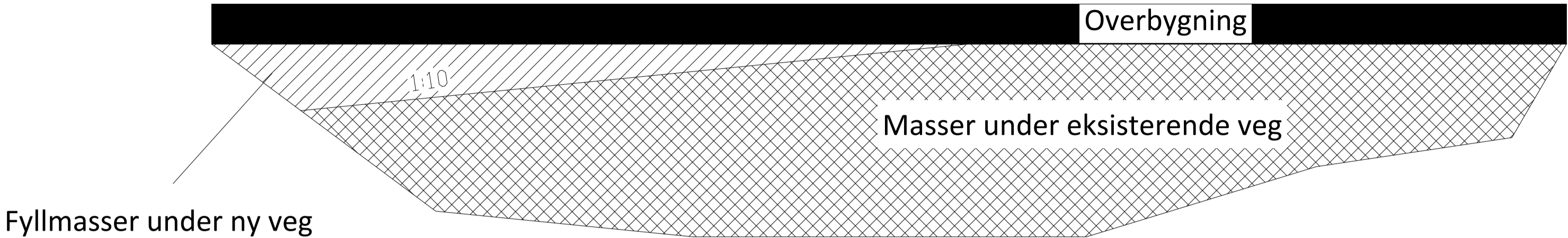
Prinsippskisse: utkiling av masser i lengdeprofil
