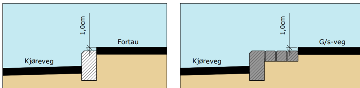
Figur 42: Avslutning av asfaltdekke inntil topp kantstein eller topp steindekke.
