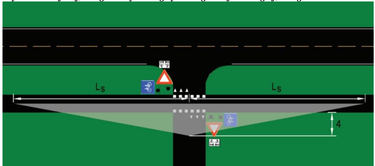
Siktsone for kryss mellom forkjørsregulert sykkelveg/sykkelveg med fortau og kjøreveg (mål i meter)
