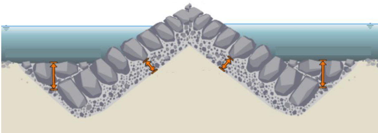
Figur 27: Prinsipp tilpasset basert på figuren over, med tosidig plastring av bune ved inntak.
